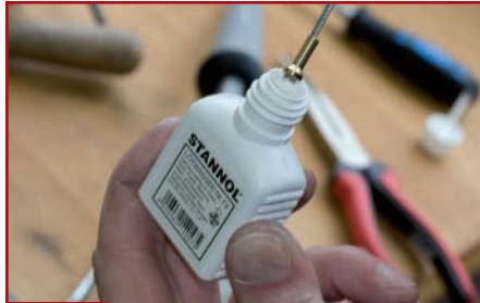
2. Bowdenzugende mit Löt-Nippel in Lötwasser reinigen
