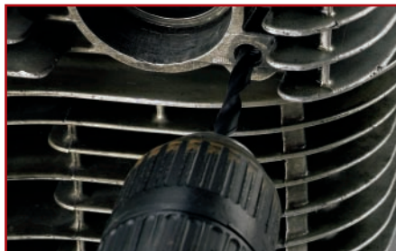
10. Helicoil-Reparatur: defektes Gewinde wegbohren ...
