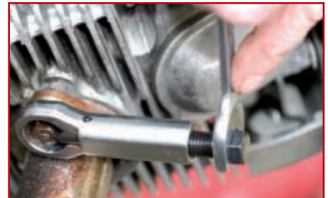
8. Mutter mit Mutternsprenger spalten
