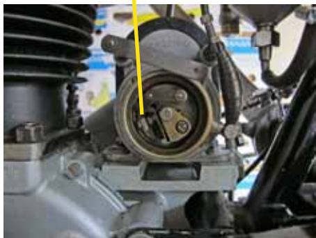
Offener Unterbrecher 0.4 mm Spätzündung: Bei OT, resp wenig früher Unterbrecher öffnend.
